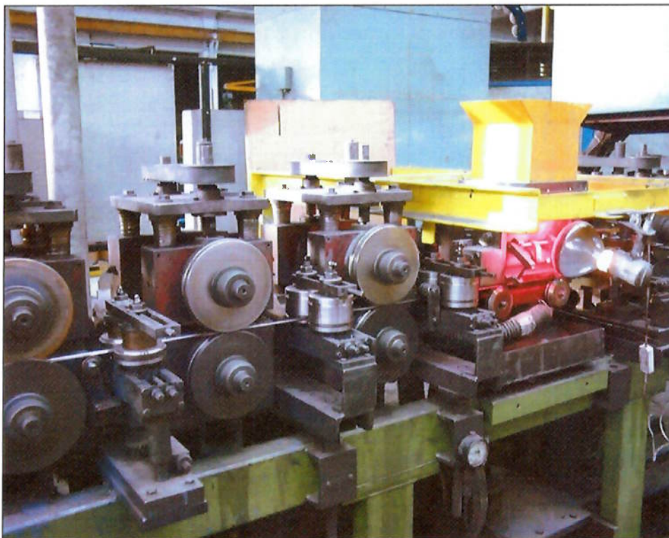
Figura 4.1 – Equipamento de fabricação de arames tubulares [19].
